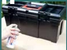
Bei der Lackierung von lackierfähigen Kunststoffobjekten, wie z. B. Werkzeugkoffern oder Modellschiffen, ist die Untergrundvorbereitung besonders wichtig! Grundieren Sie zunächst aus ca. 25 cm Entfernung Ihr Objekt mit der edding Kunststoffgrundierung, dem perfekten Haftvermittler für die anschließende Farblackierung.
