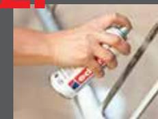
Lackieren Sie dann mit einer Farbe Ihrer Wahl aus dem edding Permanent Spray Sortiment den Fahrradständer in einem Abstand von ca. 25 cm, damit Sie einen gleichmäßigen Farbauftrag erhalten. Auch schwer erreichbare Ecken und Kanten sind mit der edding Spraydose problemlos zu besprühen!
