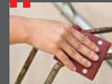
Rostige Metallgegenstände müssen vor dem Lackieren mit Schmirgelpapier bearbeitet werden und sollten dann trocken, sauber sowie frei von Fett- und Rostrückständen sein. Für noch bessere Haftung, Glanzoptimierung und als Rostschutz kann eine Vorlackierung mit edding Universalgrundierung dienen.
