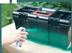
Nach ca. 15 Min. Trocknungszeit können Sie den Werkzeugkasten mit der Farbe Ihrer Wahl überlackieren. Sprühen Sie im Kreuzgang mit ca. 25 cm Abstand zum Objekt mehrere dünne Schichten, damit Sie eine gleichmäßige Oberfläche erhalten.
